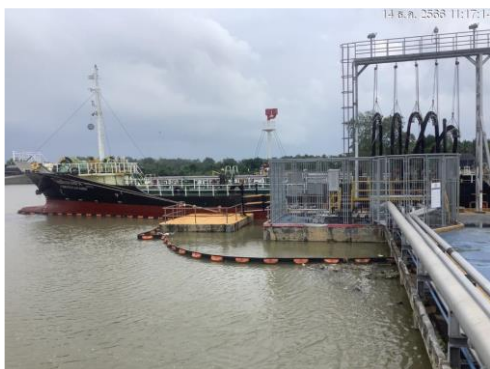
ภาพที่ 2-6 การล้อมทวน (Boom) รอบลำเรือบรรทุกน้ำมัน
